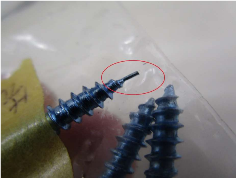
ビスの不具合(ネジ穴詰まり)
